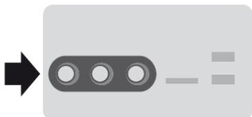
Las entradas de A/V le permiten conectar una fuente auxiliar de audio/video (sistemas de videojuego, videocámaras personales, etc.) mediante cables tipo RCA (no se incluyen) en estos conectores de entrada. Los conectores son de color amarillo, rojo y blanco, estos están ubicados en la consola central dentro del compartimiento guarda objetos, que se encuentra debajo del apoyabrazos.
